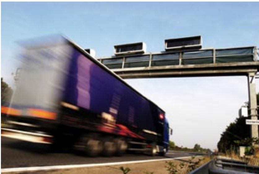
Prominentes Beispiel für eine PPP im Verkehrsbereich ist die Einrichtung eines Mautsystems für LKWs durch die Firma Toll Collect. Das Bild zeigt Videokameras auf der A 555. Um die Gebührenentrichtung zu überprüfen, sollen die Kennzeichen durchfahrender LKWs mit den Daten im Zentralrechner abgeglichen werden.
